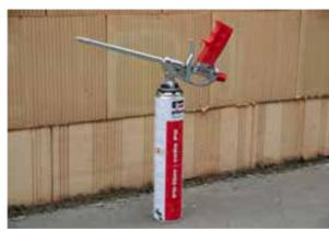
Serrez la vis de réglage. Nettoyez l'embout de colle s'il faut avec l'aérosol de PU cleaner. Gardez l'aérosol bien droit, pistolet vers le haut.
