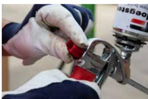
Réglez le débit au moyen de la vis de réglage et pulvérisez la mousse à plein jet pour afin de remplir entièrement le pistolet.
