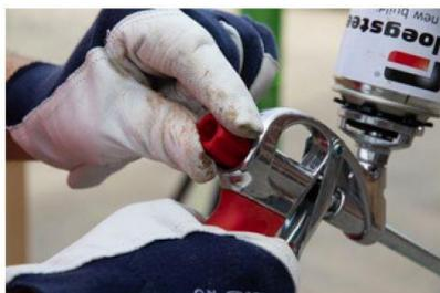
**Régalez le débit** avec la vis de réglage et faites glisser la mousse à plein jet pour remplir entièrement le pistolet.
