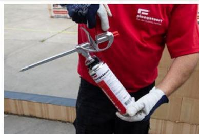
Desserrez la vis de réglage. Gardez l'ouverture de la valve vers vous. Prenez le cleaner et vissez-le sur le pistolet.
