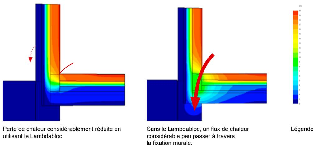
La comparaison ci-dessus entre une fixation murale au-dessus d'une paroi de cave, avec et sans Lambdabloc, illustre très clairement l'impact du Lambdabloc Ploegsteert. L'utilisation du Lambdabloc se traduit par une réduction des pertes de chaleur indéniable.
