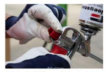
**Réglez le débit** avec la vis de réglage et faites glisser la mousse à plein jet pour remplir entièrement le pistolet.
