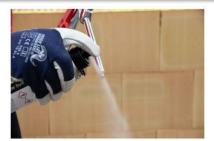
Recommencer? Agitez l'aérosol au moins 20x, nettoyez l'embout de colle s'il faut avec le PU cleaner et desserrez à nouveau la vis.
