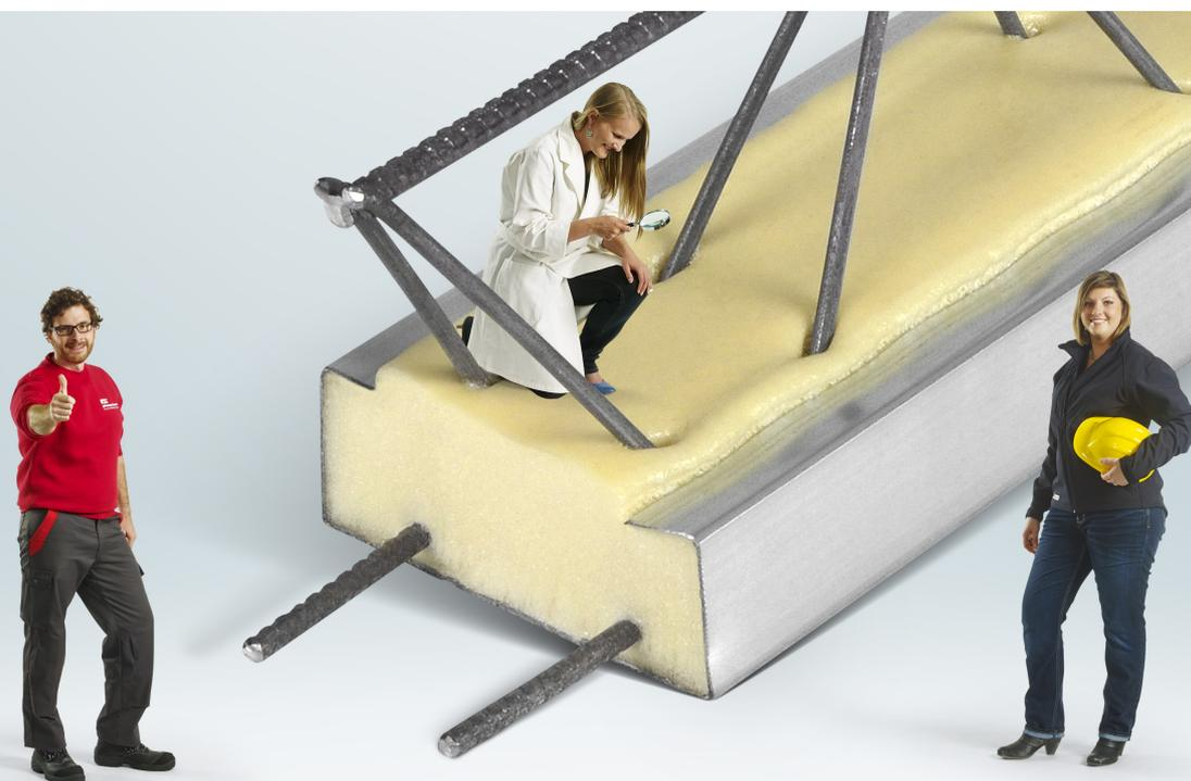
Staltolight® est le plancher le **plus léger du marché**. La poutrelle est composée d'un raidisseur de structure et d'un talon en tôle galvanisée remplie d'une isolation à base de polyuréthane. La poutrelle PSI® a un poids moyen record de **4 kg/mc**.
