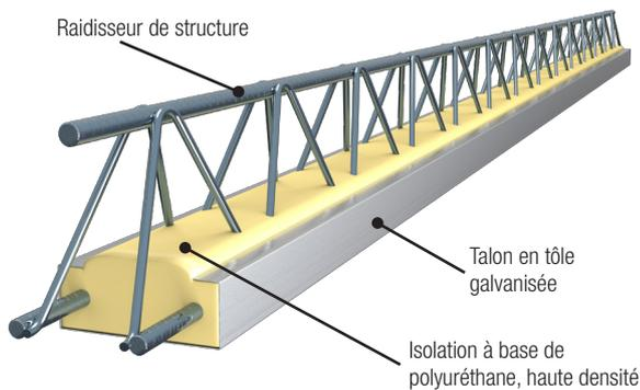
La poutrelle **PSI®** et la poutrelle renforcée **PSI® IS+** sont des poutrelles isolantes constituées d'un nouveau raidisseur ultra résistant. Les poutrelles **PSI®** sont posés sur les étaçons, avec une distance max. de 2,5 m. Les poutrelles **PSI® IS+** peuvent être mis sans étai jusqu'à 4,8 de portée libre max. Les sections d'acier de l'armature de la poutrelle varient suivant le type et la longueur de la poutrelle pour offrir une performance de tenue optimale.
